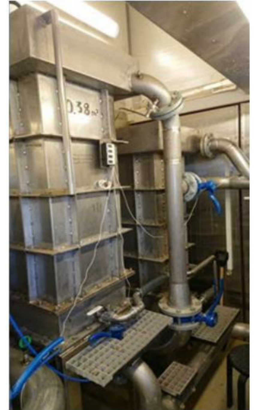
Kuva 1 Valokuvia Moduleflow Oy:n pilot - yksiköstä. Vasemmalla olevassa kuvassa näkyvät testikontit, keskellä olevassa kuvassa pääyksikkö sisältä ja oikealla olevassa kuvassa sähkökoagulaatiomoduulit.
